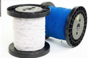
**Description :** Utilisés dans les applications haute fréquence, les fils et câbles Litz sont construits avec des fils de cuivre émaillés de petit diamètre (0,04 mm à 5 mm) pour réduire les pertes « effet de peau » générées par les courants électromagnétiques opposés (courants Eddie). Les câbles sont construits de telle sorte que les pertes « d'effet de proximité » sont également réduites.
