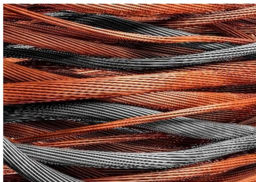
**Description :** Câbles constitués de fils fins (diamètres de 0,05 à 2,5 mm) tressés ou non de cuivre électrolytique recuit poli ou étamé. Il est possible de réaliser des câbles avec d'autres alliages (Nickel et Argent). La section transversale de nos conducteurs peut être circulaire ou carrée, avec une section allant jusqu'à 1200 mm<sup>2</sup>. Nous fabriquons également des sections de gabarit américain (AWG / MCM).
