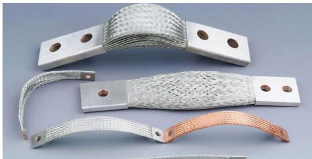
**Description :** Les connecteurs flexibles en cuivre tressé sont constitués de fils de cuivre électrolytiques. Nous pouvons les fabriquer à différentes mesures (mm), sections (mm<sup>2</sup>) et formes, en fonction de chaque besoin d'installation (section x largeur x hauteur x longueur). Nous proposons également des bornes très diverses (métriques et quantités différentes). Possibilité de fabrication avec du cuivre poli ou étamé.
